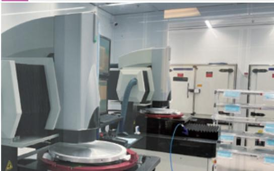
半導体やFPDの製造装置の部品・治具をクリタの工場でお預かりして解析を行い、付着した汚れの洗浄・除去または新たな機能を付与することでお客様の生産性の維持・向上に貢献します。
