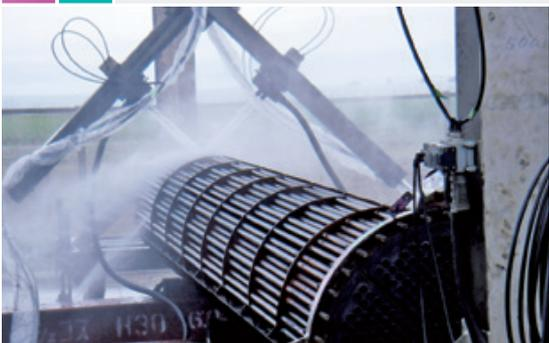
コンビナートや発電所などの大型プラントを安全かつ効果的に稼働させるため、ボイラや熱交換器、配管に蓄積した汚れを薬品や高圧水などにより洗浄します。
